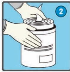
2 Vliestuchrolle einsetzen / insert the fleece roll
