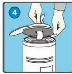
4 Vliestuch durch Deckel führen / pass the fleece cloth through the lid
